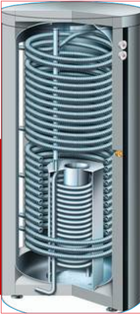
Viessmann Vitocell-360-M Schichtlade-Puffer-Speicher Warmwasser-Edelstahl-Spirale Liter-750 D-960 mm H-210 mm G-200kg
